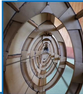
Dem Konstrukteur war ein möglichst einfacher Aufbau des Flugzeuges aus dem Werkstoff Holz wichtig. Die Tragfläche war einteilig, also nicht wie bei anderen Segelflugzeugen zweiteilig (linker und rechter Flügel), was Vorteile in der Festigkeit (beim Kunstflug sehr wichtig) und - durch den Entfall von Metallteilen welche die Flügel miteinander verbinden mussten – im Gewicht brachten. Das Seitenruder ist mit Holz beplankt.
